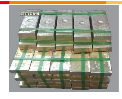
现代锡冶炼包括四个主要生产工序:锡精矿预处理、还原熔炼、精炼和烟尘与炉渣的处理。其中,锡精矿的还原熔炼主要有电炉熔炼或者澳斯麦特炉两种生产工艺。锡精矿经过还原熔炼处理后,形成含锡量80%左右的粗锡用于精炼。精炼通常采用火法冶金和电解法冶金两种方法,形成含锡量99.0%以上的精炼锡。锡加工中间产品主要有精锡产品、锡铅焊料锭、锡基铸造合金锭以及锡基轴承合金锭等。
